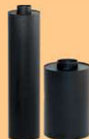
Труба защитная в сборе (сэндвич) d = 245 × 1,0 мм / 114 × 3,0 мм L = 1000,500 мм Материал – сталь ст3пс/08пс, минвата
