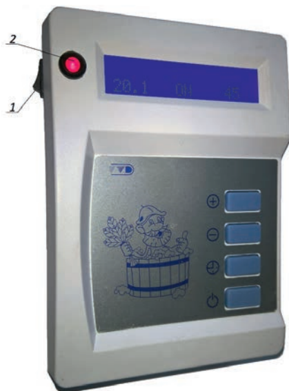
Рис. 6 Пульт управления паротермальной печью «ПремьераРуса» с ЭГПП
