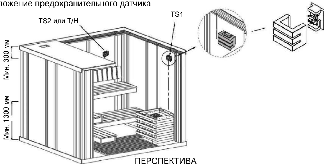
Рис. 7. Расположение предохранительного датчика
