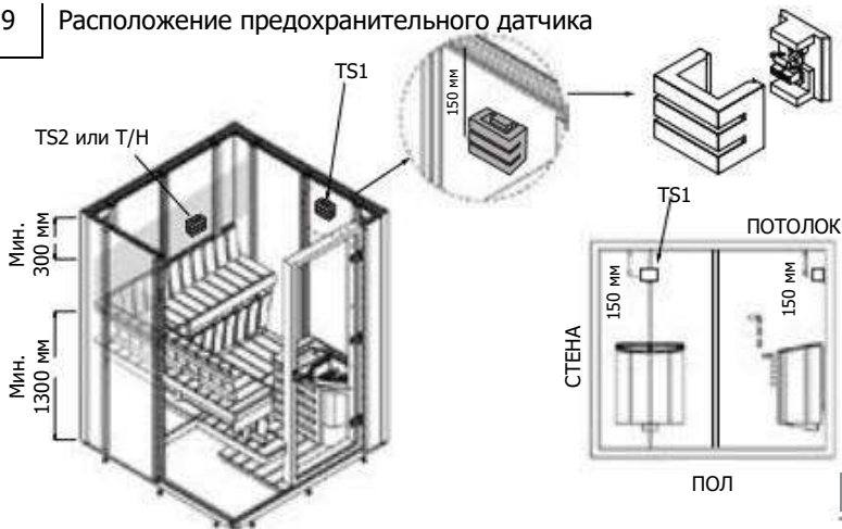
Рис. 9 | Расположение предохранительного датчика
