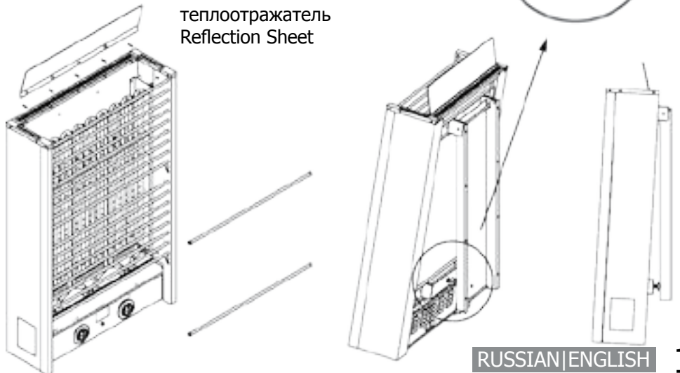
Рис. 4 | Регулировка угла печи Fig. 4 | Adjusting heater angle
