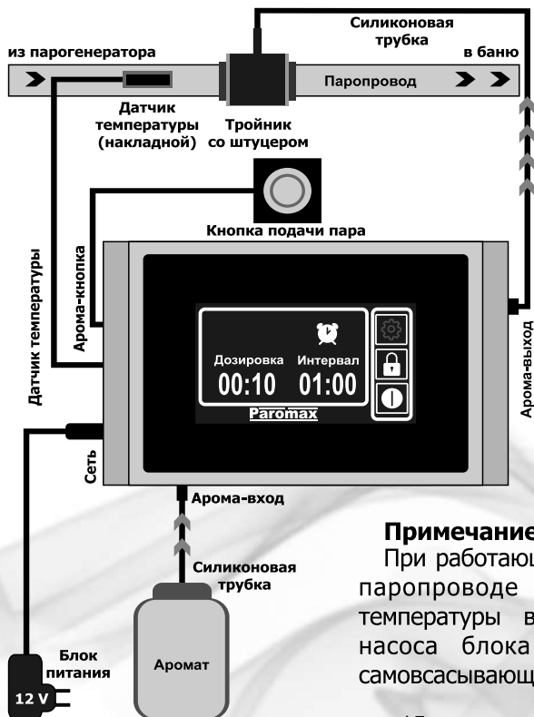
Рис. 2. Схема подключения диспенсера ароматов
