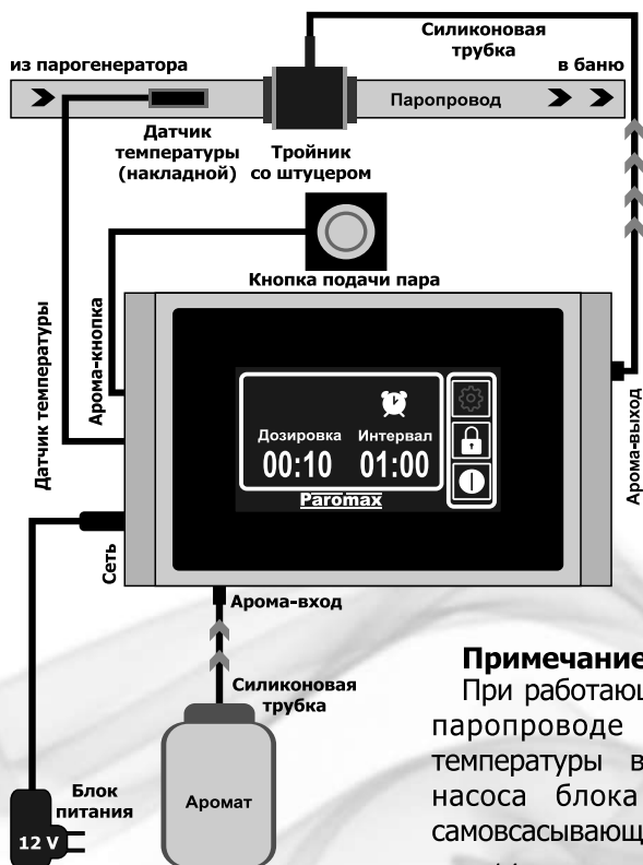
Рис. 2. Схема подключения диспенсера ароматов
