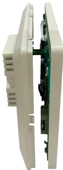
Рис. 23.: Шаг 2. Разъединение панелей дисплея
