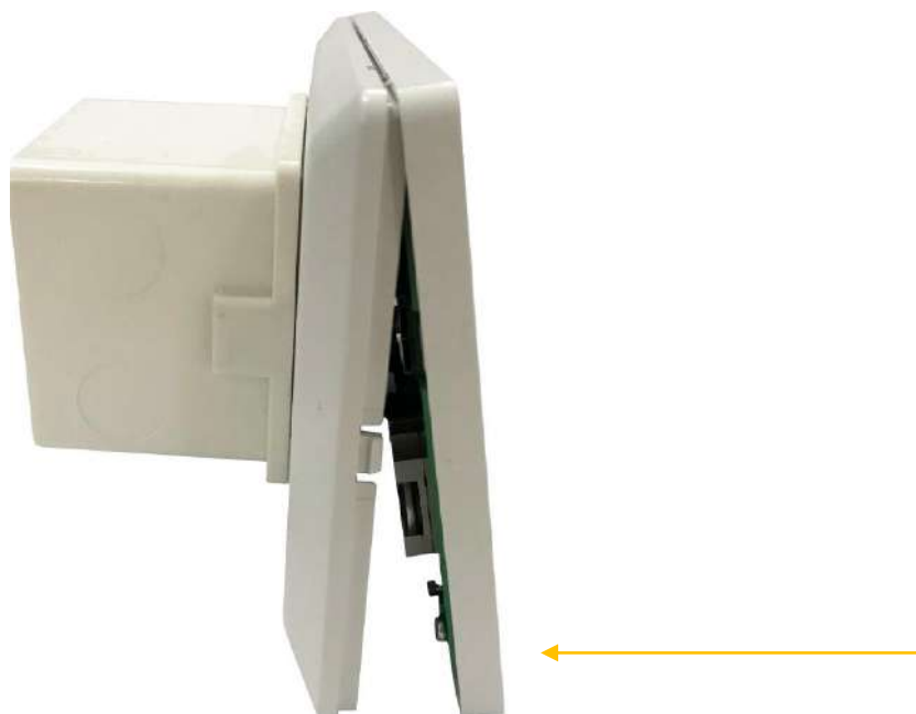
Рис. 28.: Шаг 7. Монтаж передней панели дисплея.
