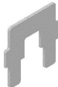
Рис 13.: Перемычка. Двухштырьковая. Изометрия.
