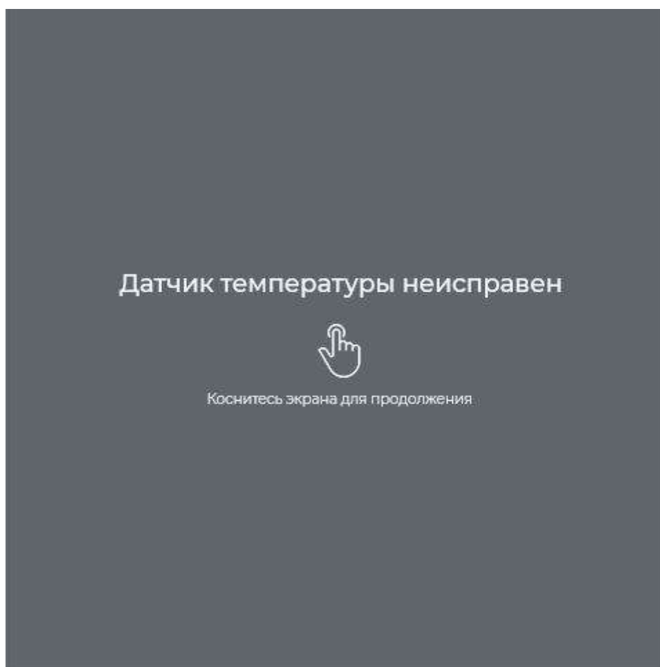
Рис. 49.: Ошибка неисправности датчика температуры.
