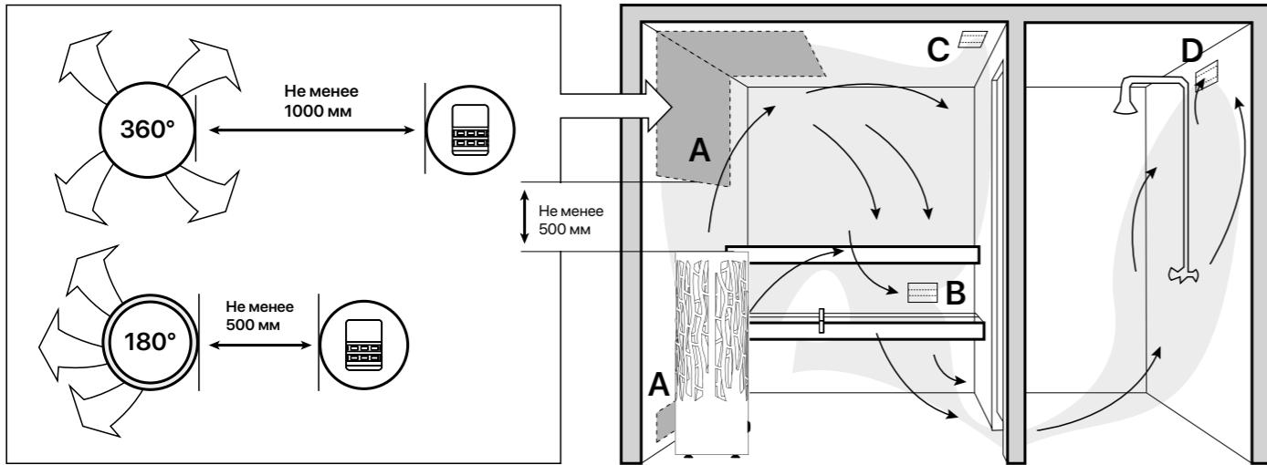
A. Размещение приточного вентиляционного отверстия. Если используется механическая вентиляция, поместите вентиляционное отверстие над каменкой. Если вентиляция естественная, поместите вентиляционное отверстие под или рядом с каменкой. Диаметр трубы для притока воздуха должен быть 50-100 мм.
